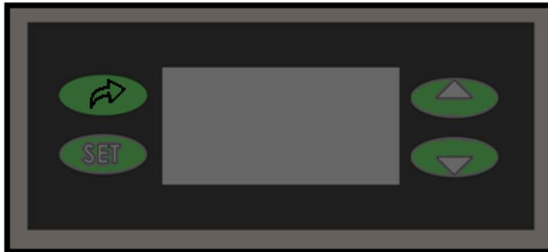
El temporizador es un elemento adicional que poseen los equipos CV-50 y CV-100 que permite programar el tiempo de cocción de cada producto. De esta manera el equipo le indica la finalización del tiempo programado mediante una alarma sonora. Esto facilita tener un tiempo de cocción de cada producto. Gracias al temporizador digital “TEMPUS”.
